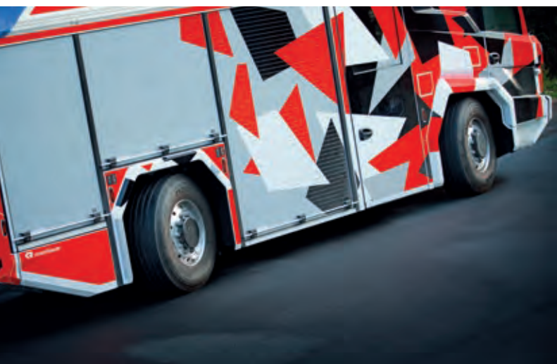
Positionnement parallèle des roues sur les deux essieux pour des manœuvres dans des espaces confinés.
